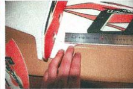
11 Réalisez une saignée de 40mm comme indiqué sur la photo.
