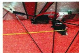
Réalisez la commande de direction par câbles aller-retour. Les fils devront être collés au niveau des passages dans le palonnier de servo et dans le guignol.
