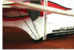
Collez également au niveau du pied de dérive.
