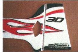
7 Bisezutez au niveau de l'articulation comme vous l'avez fait pour les ailerons et la profondeur. A noter qu'ici, le biseau est à faire au niveau de la dérive et du volet de direction afin de garantir le maximum de débattement possible.
