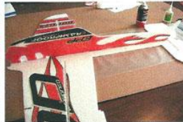
10 Retournez l'ensemble aile / fuselage horizontal et stab et collez la partie verticale inférieure du fuselage en place en prenant soin d'obtenir un angle de 90°.
