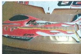
9 Séparez la partie verticale et horizontale du fuselage comme indiqué par les marques jaunes.
