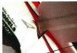
Insérez et collez le guignol (double de profondeur) dans une saignée à réaliser sur le volet de profondeur. Notez que le guignol est asymétrique. La partie la plus longue est à placer du côté où vous avez réalisé le biseau d'articulation.
