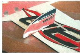
14 Collez les SFG inférieur sur l'intrados de chaque demi aile en positionnant le bord marginal à l'aplomb du bord de fuite de l'aile.
