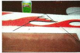
Continuez les croisillonnage comme indiqué. Notez que le croisillonnage doit être fait des deux côtés.
