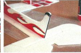
16 Renforcez l'arrière du fuselage à l'aile du morceau de plat carbone de 3x0.5
