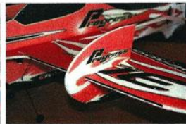
Vous pouvez maintenant coller les SFG supérieurs en place en respectant un angle de 90°
